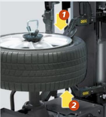
**Lo stallonamento** viene fatto tramite due rulli con movimento sincronizzato.
